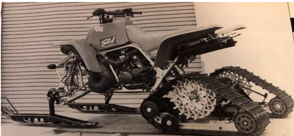
VTT avec un ensemble de conversion de SCI de l'année 1995
